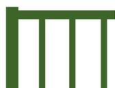
Remplissage en barreaux 30 x 20 mm
