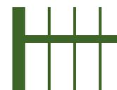
Remplissage en barreaux 50 x 10 mm ou Ø25mm
